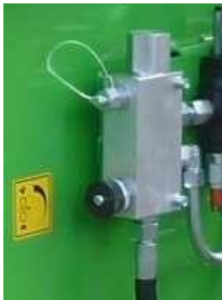
Söötiskiiruse regulaator Laadimisrullide kiiruse reguleerimine vahemikus 12–35 m/min
