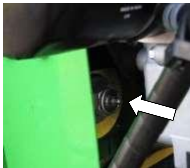
Pingutusratta määrdenippel Määrimine iga 40 töötunni järel (kord nädalas) (LTA 3EP MOL Lition)
