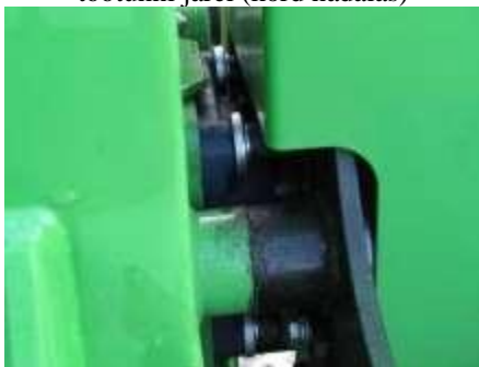
Hakkeratta määrdenippel Määrimine iga 40 töötunni järel (kord nädalas) (LTA 3EP MOL Lition)
