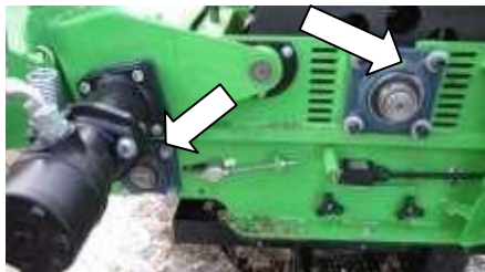
Hakkeratta ja alumise laadimisrulli määrdeniplid. Määrimine iga 40 töötunni järel (kord nädalas)
